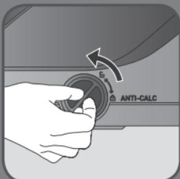
**CS** Přístroj umístěte nad umyvadlo a vyšroubujte klobouček „odvápnení“ otáčením proti směru hodinových ručiček.
